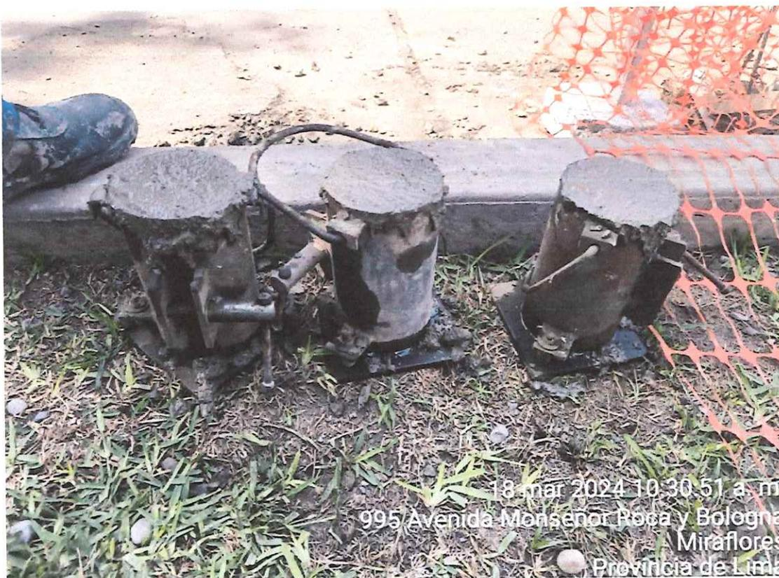
Muestreo de los testigos de concreto y así mismo vaciado de concreto en martillos.
