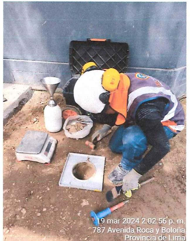
Se aprecia en la toma fotográfica que se está realizando los ensayos de densidad de campo en martillos y así mismo muestras de los testigos de concreto
